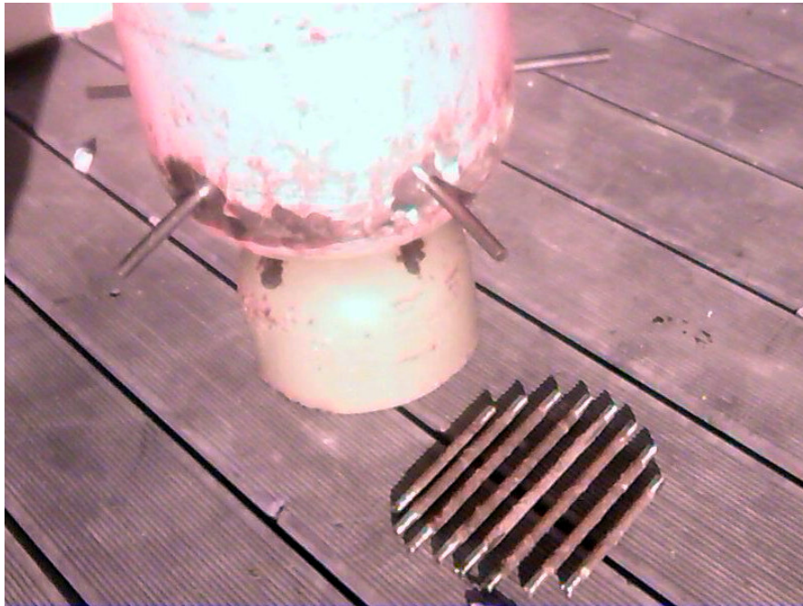
Abbildung 4.5: Innenleben des Reaktors vor dem Schweißen
